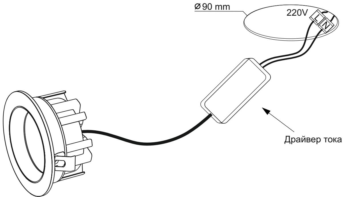
**ВАЖНО:** Установка светильника должна производиться при обесточенной электросети.
